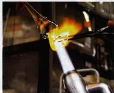
バーナーで棒やパイプ状のガラスを熱して、柔らかくなったところで曲げたり延ばしたり、接合したり
